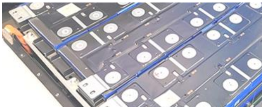
电池CCS/ Battery CCS
